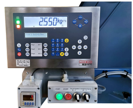
Gewichtsanzeige mit Bedienpult und Vorwahlzählwerk mit Stopp-Funktion. Es werden nur fertig gewogene und abgeworfene Portionen gezählt.
